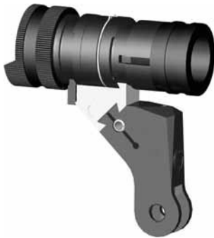
Bild 9: Universalkornträger zu Stgw 57 (Normalmontage), diverse Fabrikate
